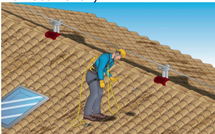
Figura 3 - Esempio di ancoraggio puntuale permanente
