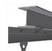
Figura 4 - Esempio di ancoraggio lineare permanente rigido
