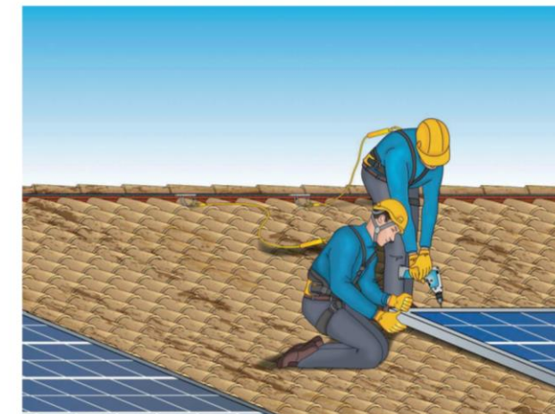
Figura 4 - Esempio di ancoraggio lineare permanente rigido
